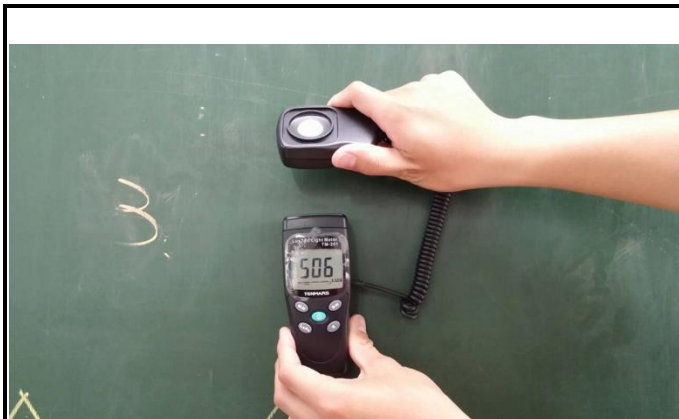
▲照片說明：黑板照度
